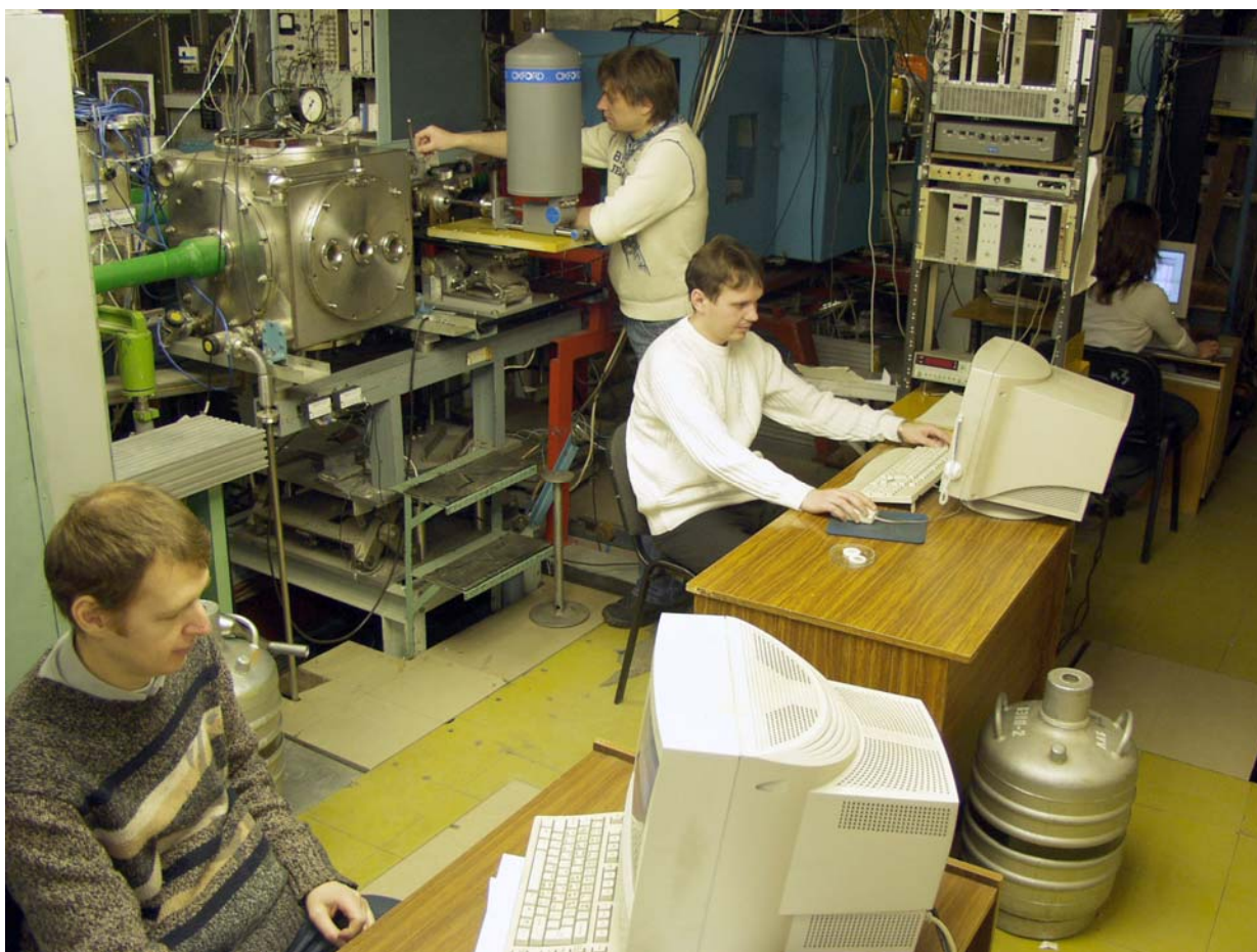
Рис. 14. Станция “Рентгенофлуоресцентный элементный анализ” на ВЭПП-3.
