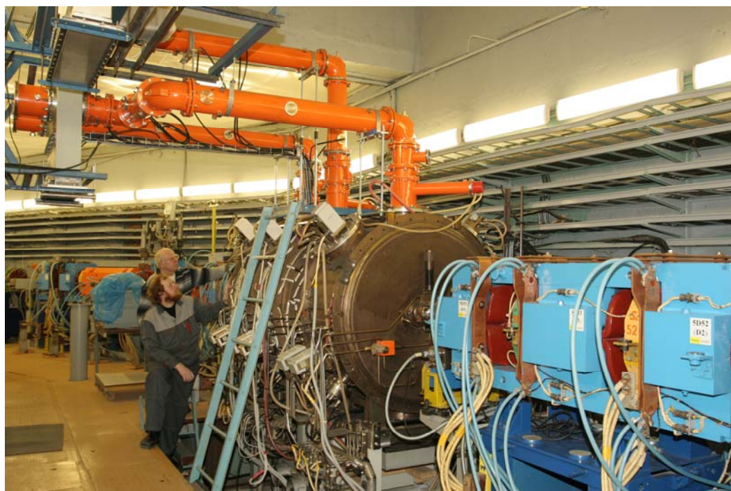
Рис. 51. Новая ускоряющая структура источника СИ «Сибирь-2» из трех биметаллических 180 МГц резонаторов.
