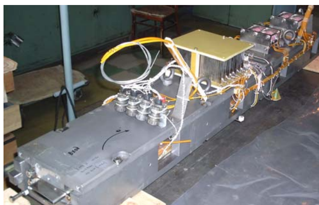
Рис. 60. Магнитная система 119-полюсного вигглера с полем 2.2 Тл и периодом 31 мм для накопителя ALBA-CELLS (Испания)
