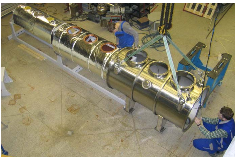
Рис. 56. Процесс сборки в ИЯФ 49-полюсного вигглера с полем 4.3 Тл для накопителя DLS (Англия) в собственном криостате.
