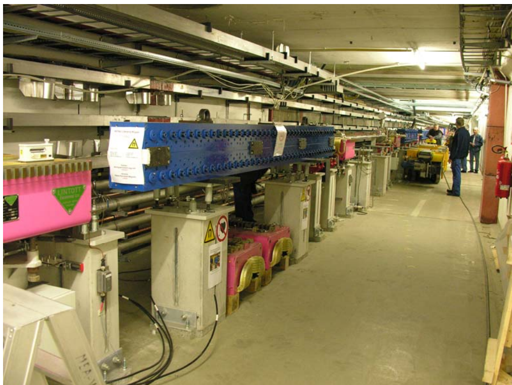
Рис. 61. Установка вигглеров в прямолинейных промежутках PETRA- III (2008 г.)
