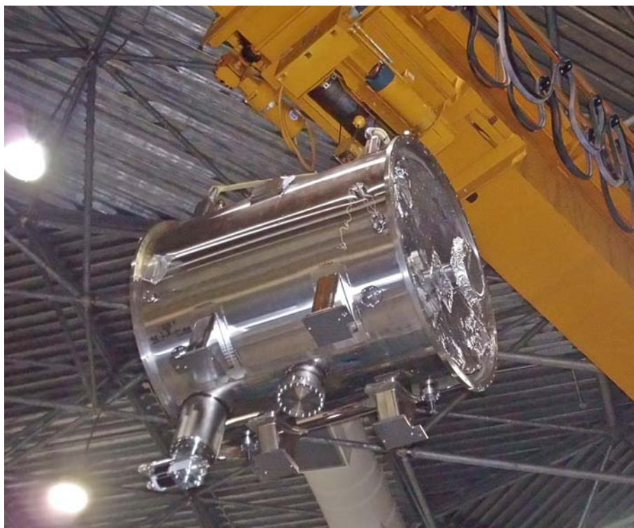
Рис. 58. Процесс переноса на накопитель LSU-CAMD модернизированного шифтера с полем 7.5 Тл.
