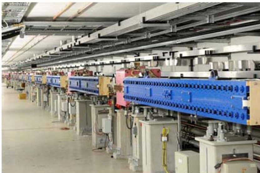
Рис. 62. Вигглеры производства ИЯФ на работающем источнике СИ PETRA- III (из доклада Hermann Franz на Международной школе молодых ученых, 11 ноября 2009, Москва).
