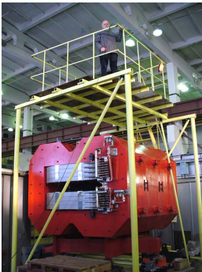
Рис. 63. Радиационно-стойкий дипольный магнит N типа.
